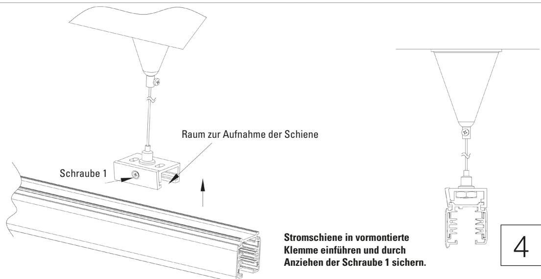
Stromschiene in vormontierte Klemme einführen und durch Anziehen der Schraube 1 sichern.
