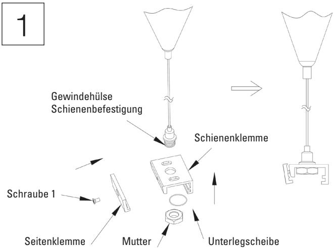
1. Gewindeglocke der Deckenbefestigung in die mittlere Bohrung der Schienenklemme einführen und mit Unterlegscheibe un Mutter verschrauben.
