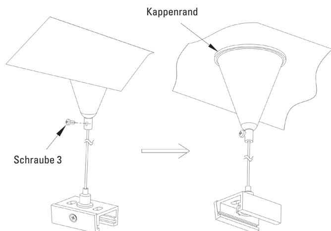
1. Deckenbefestigung mit der Kappe abdecken.
