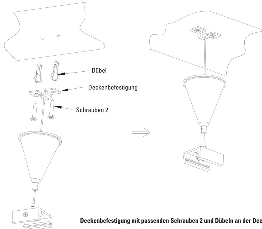
Deckenbefestigung mit passenden Schrauben 2 und Dübeln an der Decke montieren.
