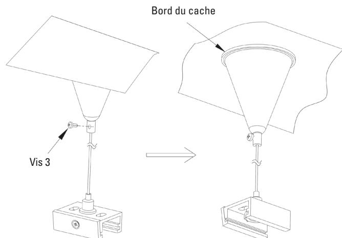
1. Poser le cache sur la fixation au plafond en veillant à ce que le bord du cache affleure bien au plafond.
