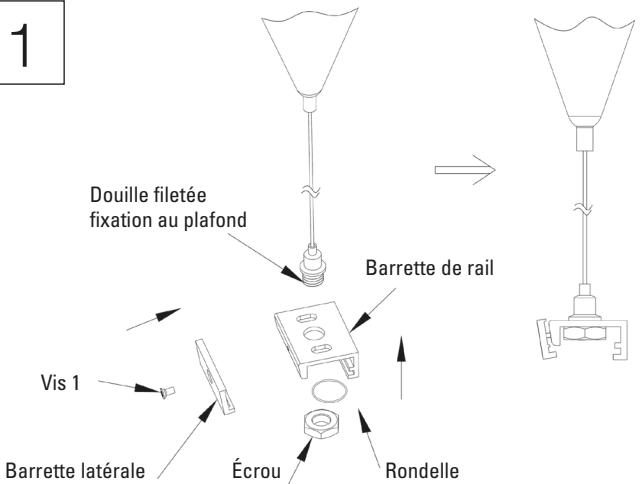
1. Introduire la douille filetée de la fixation au plafond dans le perçage central de la barrette de rail, visser avec la rondelle et l'écrou.
